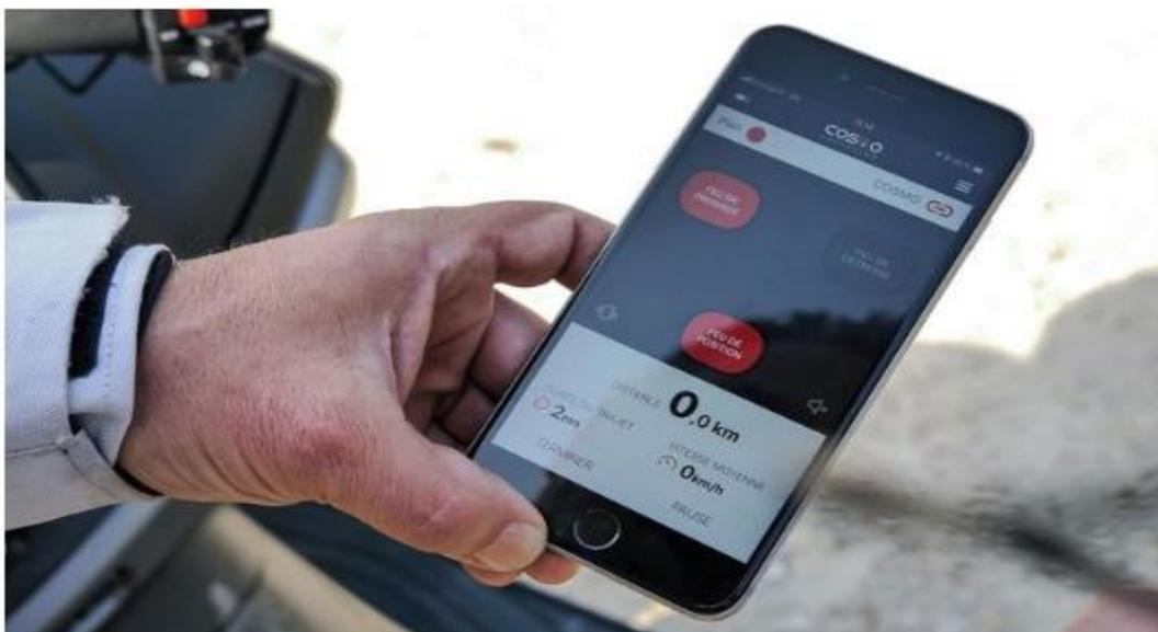
Enfin, sa dernière fonction, la plus connectée, permet de prévenir automatiquement les secours en cas de choc. La géolocalisation et la connexion téléphonique permettent de faire intervenir les pompiers les plus proches. Un premier niveau d'alerte envoie seulement un SMS aux proches en cas d'impact modéré. Le motard peut alors prévenir un opérateur de la fausse alerte.
